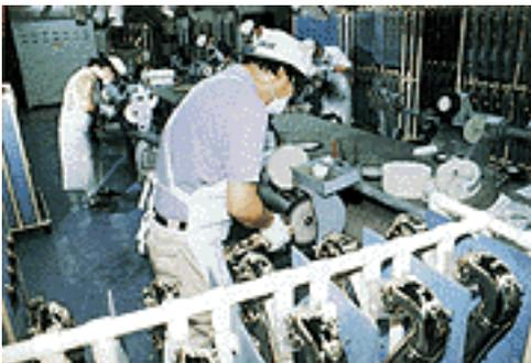
Mit Hilfe einer Polierscheibe und einer speziellen Politur wird nun die Oberfläche des Saxophons glattpoliert.
