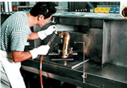
Nachdem die Tonlöcher auf dem Schallbecher und dem Bogen fertiggestellt sind, werden die zwei Teile zusammengelötet.
