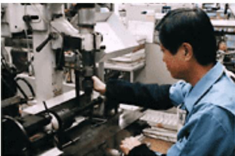
Die Tonlöcher werden mechanisch auf dem Korpus angebracht und anschließend von innen unterhöhlt. Dieser Schritt hat einen gewaltigen Einfluss auf die Klangqualität. Die Löcher der exklusiven, handgefertigten Modelle werden von Fachkräften sorgfältigst in Handarbeit angelegt.
