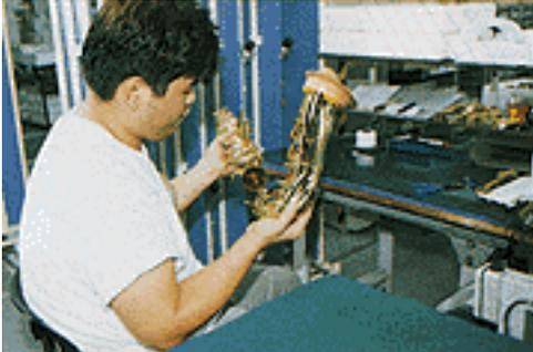
Nachdem der Schallbecher, der Bogen und die Korpussteile einzeln montiert worden sind, werden sie nun zusammengefügt.
