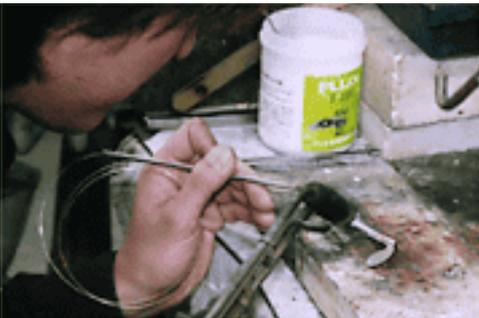
Sämtliche Komponenten der Klappen werden nun individuell zusammengelötet.
