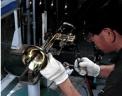
Bei diesem Schritt löten Spezialisten in Handarbeit den Schallbecher, das Ventilgehäuse und die Rohre zusammen.
