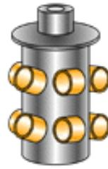
Die Ventil Ports werden durch bronzieren an das Futter angebracht. Das Flussmittel, welches beim Bronzieren verwandt wird, wird sorgfältig entfernt. Die inneren Durchmesser der sich verjüngenden Röhren, die Schrauben und andere Teile werden präzise gearbeitet.
