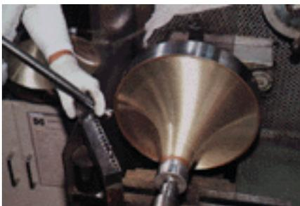
Bei diesem Schritt wird ein Messingteller in eine runde Form geschnitten, gedreht und auf einem Dorn geformt.
