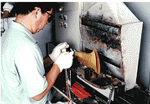
Bei diesem Schritt wird eine einzelne Messingplatte an der Kante entlang verschweißt, und die Schweißnaht mit einer Maschine namens Schweißnahtroller geglättet.
