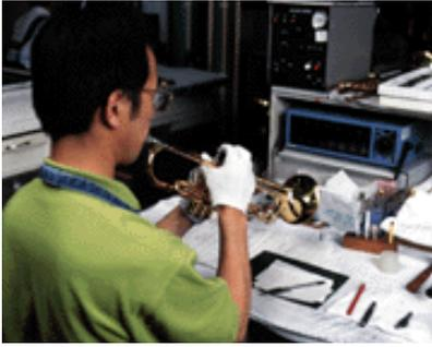
Bevor eine Trompete die Fabrik verlässt, durchläuft sie eine strenge Qualitäts- und Bespielbarkeitskontrolle. Dieses schließt die Überprüfung ihrer Intonation durch ein spezielles Stimmgerät und eine Luftdurchlässigkeitsprüfung mit ein.
