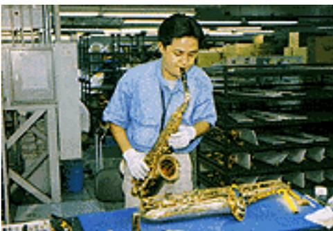
Bevor ein Saxophon die Fabrik verlässt, durchläuft es eine genaue Inspektion und Spieltests. Dies beinhaltet die Kontrolle der Stimmung mit Stimmgeräten und das Ausschließen von Luftlecks mit einem speziellen Luftleck-Tester.
