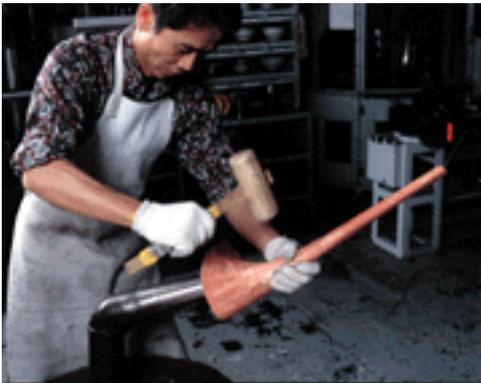
Bei dieser traditionellen Verfahrensweise wird ein fächerförmiges Stück Blech mit einer ungefähren Dicke von 0,5 mm langsam und vorsichtig zu einer Röhre geformt. Anschließend werden die Nähte verschweißt. Ein Spezialist hämmert nun die Röhre, bis er eine Glockenform erreicht hat. Dieser aus einem Stück gefertigte Schallbecher wird für anspruchsvolle Instrumente und für Profitrompetenmodelle verwandt.
