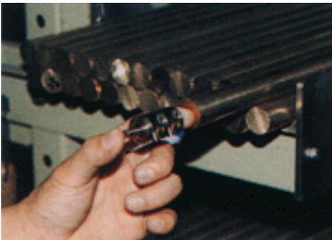
Um den Rotor zu formen, wird mit Hilfe einer computergesteuerte Drehbank ein Messingstab hergestellt.
