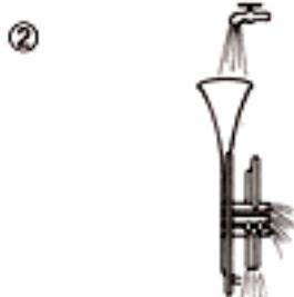
2. Nachdem das Innere gereinigt wurde, spülen Sie es mit klarem Wasser, um die Metallseife zu entfernen. Danach trocknen Sie mit weißer Gaze die Röhre komplett aus. Fetten und ölen Sie abschließend.
