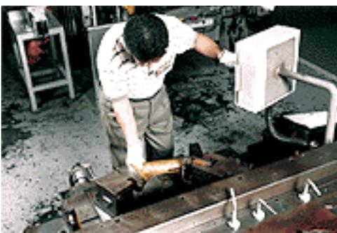
Nun wird mit Hilfe eines Hammers der entstandene Kegel zu einer groben Glocke geformt. (Für Custom Modelle)
