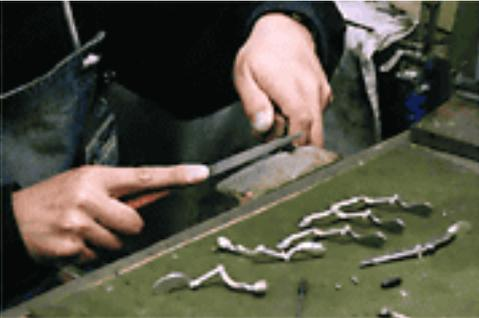
Die Außenseite der Komponenten wird nun mit Hilfe einer Schablone geschnitten. Bei den handgefertigten Exklusivmodellen wird dieser Schritt in Handarbeit gemacht.
