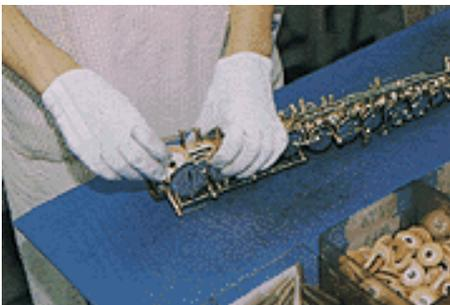
Hierbei werden die Klappen und andere Kleinteile und die Polster montiert.
