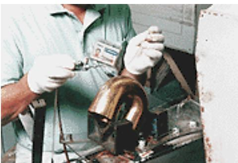
Nachdem zwei Messingplatten geformt und zusammenschweißt wurden, wird die Schweißnaht geätzt.
