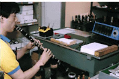
Bevor ein Instrument die Fabrik verlässt, durchläuft es einen gründlichen Funktionstest. Dieser Test deckt Punkte wie Klang und Nachhall, Klappenbeweglichkeit (Berührung), Klappenreaktion, Intonation und Spielgefühl ab. Die Stimmung wird mit einem Stimmgerät überprüft.
