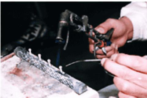
Die Klappenpfosten werden durch Löten mit den anderen Klappenteilen, wie dem Klappengestänge, verbunden.
