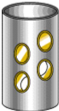
Die Außenseite des Kolbens wird nun so lange poliert und gerieben, bis eine exakte und glatte Oberfläche gebildet wird.
