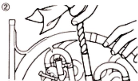
2. Ein Reinigungstuch wird so um einen Reinigungsstab gewickelt, dass auch die Spitze aus Metall verdeckt ist.
