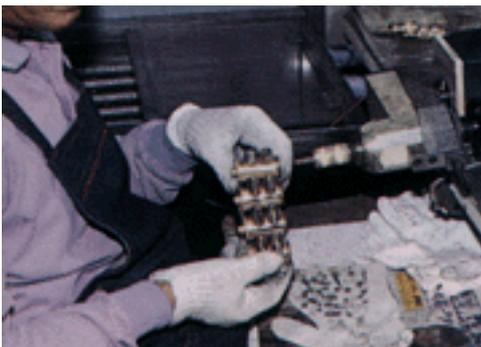
Bei diesem Schritt wird der Rotor und das Ventilfutter akribisch genau gewickelt und anschließend getestet.
