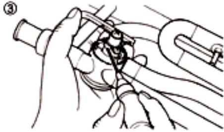
3. Kleine Mengen Öl werden ebenfalls auf die Unterseite des Zapfens und der Lager aufgetragen. Nach Auftragen des Öls werden die Kappen wieder geschlossen und der Hebel bewegt, damit sich das Öl verteilt.
