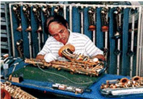
Bei diesem Schritt wird das nun fast fertiggestellte Saxophon diversen abschließenden Justierungen unterzogen (zum Beispiel wird die Beweglichkeit der einzelnen Klappen geprüft), wobei spezielle Werkzeuge zum Einsatz kommen.
