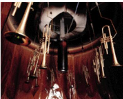
Das Instrument durchläuft nun einen Nebel aus Lackpartikeln, die elektrostatisch auf die Trompete aufgetragen werden. So entsteht eine starke, konstante Schicht.
