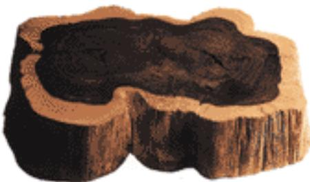
Klarinetten werden aus Grenadill hergestellt, ein Holz, das zuerst für einige Jahre trocknen muss. Es werden sowohl der natürliche Trockenprozess wie auch ein computergesteuerter mechanischer Trockenprozess zum Einsatz gebracht.
