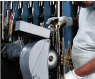
Nun wird mit Hilfe einer Polierscheibe und eines Poliermittels die Oberfläche poliert.
