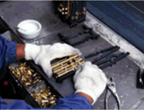
Die Ventilgehäuseteile werden in eine spezielle Spannvorrichtung eingepasst und dann durch einen Ofen geführt, um die Bestandteile ohne Verzerrungen miteinander bronzieren zu können.
