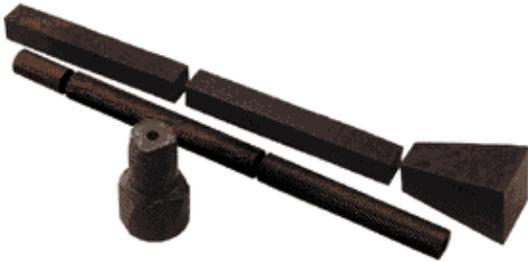
Zuerst werden die Löcher in das unbearbeitete Holz gebohrt. Danach wird das Äußere mit Hilfe eines computergesteuerten Gitters geformt.
