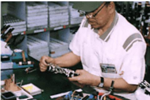
Minutiös genau werden nun Klappen und Stangen, sowie Abstände zwischen Polster und Tonloch, genau justiert um ein Klappern zu eliminieren.
