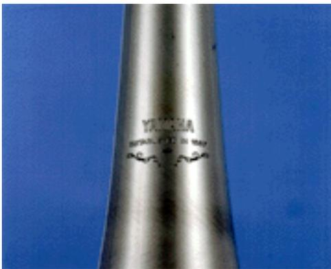
Zum Schluss wird das Instrumentenhersteller Logo aufgebracht. Das Logo wird computergesteuert mit größter Präzision eingraviert.
