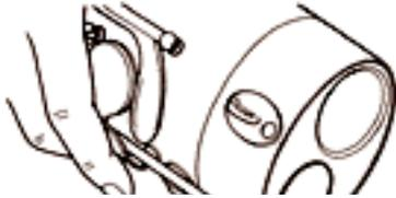
1. Lassen Sie Feuchtigkeit, die sich in dem U-Bogen gesammelt hat, über die dünnere Röhre abfließen. Beachten Sie, dass sich immer dann Feuchtigkeit ansammelt, wenn das gebräuchliche h# Tonloch nach unten zeigt.
