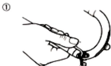
2. Poliergaze wird um einen Reinigungsstab gewickelt, so dass auch die Spitze aus Metall verdeckt ist. Reinigen Sie damit das Innere der äußeren und inneren Züge. Wenn Sie den Stab entfernen, stellen Sie sicher, dass keine Gaze im Innern der Röhre verbleibt.
