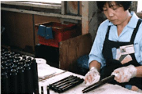
Um die natürliche Klang und Holzqualität von Grenadill zu bewahren, und um den Korpus vor Schäden durch Feuchtigkeit und anderer Faktoren zu schützen, wird die Oberfläche mit einem speziell von Yamaha entwickelten Öl bearbeitet.
