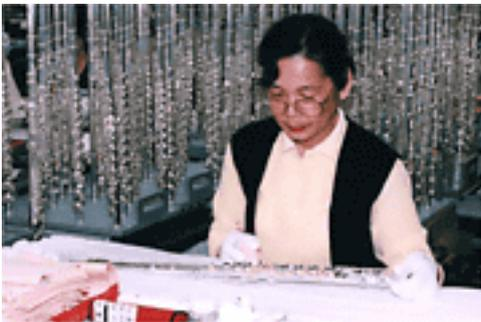
Nach einer strengen Kontrolle werden Klappen und Korpus poliert, bevor die Querflöte verschifft wird.
