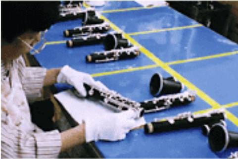
Bevor die Klarinette versendet wird, werden nach der strengen Inspektion sowohl Klappen wie auch der Korpus poliert.
