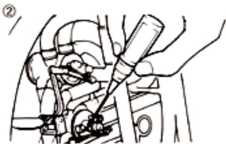
2. Kleine Mengen Öl werden ebenfalls auf die Unterseite des Zapfens und der Lager aufgetragen. Nach Auftragen des Öls werden die Kappen wieder geschlossen und die Hebel bewegt, damit sich das Öl verteilt.
