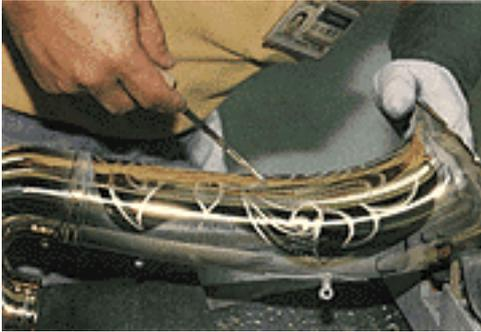
Bei den Custom- und Profimodellen wird der Schallbecher von einem erfahrenen Handwerker von Hand Graviert. Dieser Vorgang dauert zwischen 30 bis 50 Minuten pro Saxophon. Es benötigt eine ausgefeilte Technik und langjährige Erfahrung für diesen Schritt.
