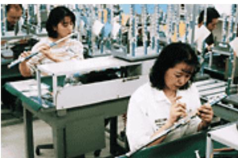
Winkel, Lücken etc. werden feinabgestimmt, um sicherzustellen, dass die Klappenpfosten, Polster und andere Teile keine Lecks aufweisen oder klappern.
